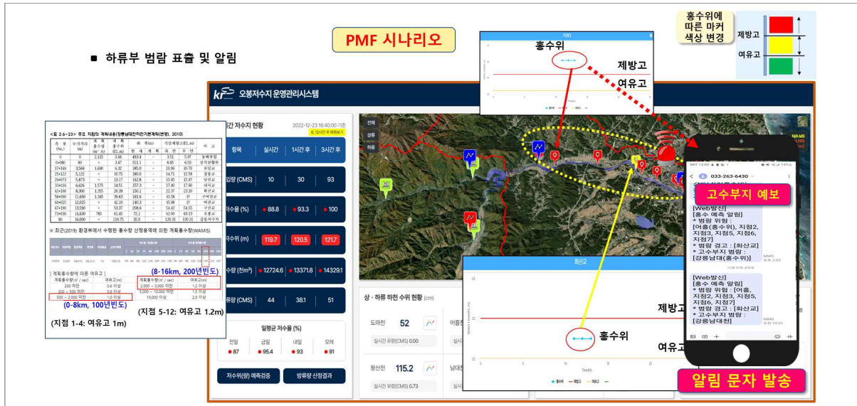
<그림 28> 인공지능을 이용한 저수지 수위 예측 및 스마트 방류 시스템 대쉬 보드 예시 (한국농어촌공사, 2023)
